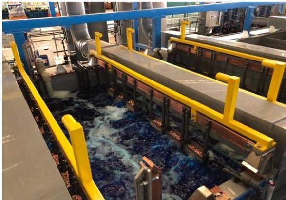
Le vasche di trattamento (di tipo elettrolitico) contengono un'adeguata armatura galvanica realizzata in piatto di rame isolata con appositi supporti.
