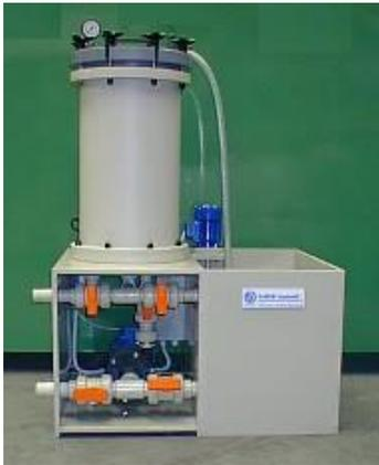
Alcuni bagni necessitano di una periodica o continua filtrazione che avviene tramite dispositivi filtranti composti da una pompa in materiale plastico a trascinamento magnetico e da un gruppo filtrante opportunamente dimensionato.
